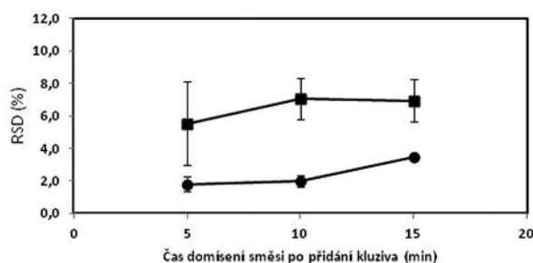
Obr. 2. Vliv času domísení na obsahovou stejnoměrnost tablet s obsahem 1 mg (■) a 10 mg (●) sodné soli warfarinu; chybové úsečky znázorňují maximální a minimální hodnotu RSD v rámci připravených šarží
